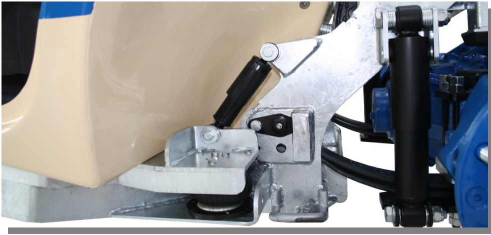
Sistema neumático de suspensión de la cabina con airbags y amortiguadores . Sistema de suspensión de chasis con resortes mecánicos y amortiguadores.
