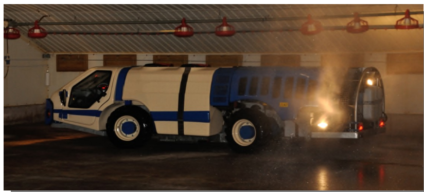
Equipo especial para la desinfección industrial con sistema de lavado de suelo.
